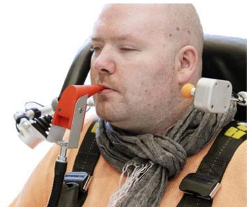
Kabellose, mundgesteuerte Computermaus. Die **IntegraMouse Plus** kann aber auch weiterhin mit einem USB-Kabel betrieben werden.
