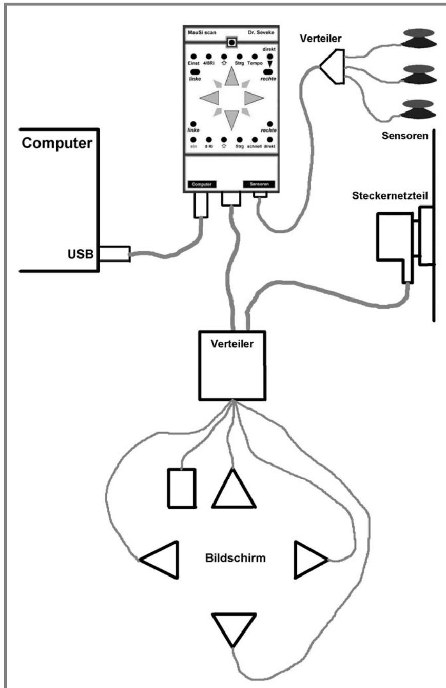
Stecken Sie das Steckernetzteil in eine Steckdose und stellen Sie an seinem Schiebeschalter für die Spannung die notwendige Helligkeit der Richtungspfeile ein.
