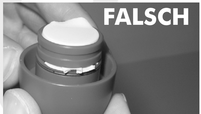
Bild 13) Membran, falsch eingesetzt
