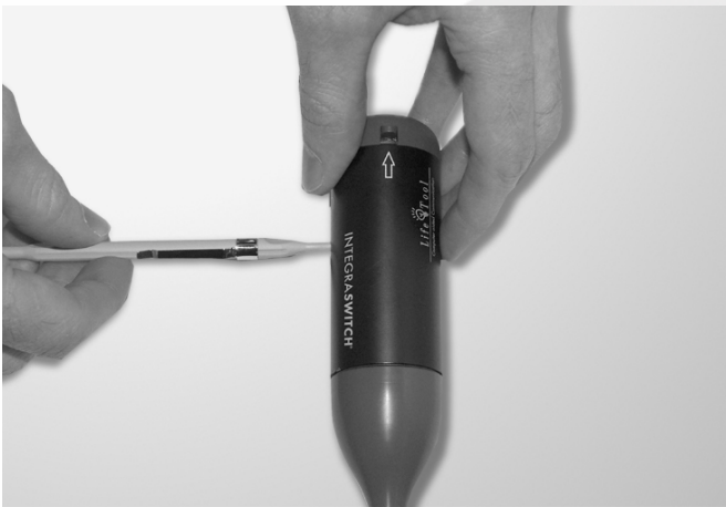
Bild 5) Justieren der für Sie passenden Saugintensität
