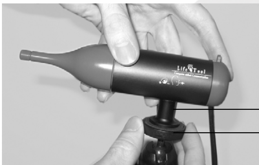
Bild 2) INTEGRASWITCH® am Stativ montieren
